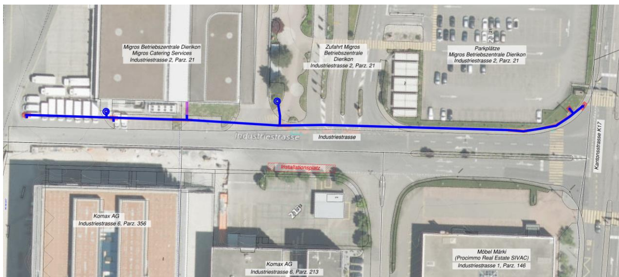
Abbildung 1: Übersicht Leitungersatz (blau), voraussichtlicher Installationsplatz (rot)
