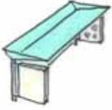
Nach Absprache und Einigung durch Gemeinden   | - z.B. Typ Luzern<br>- evtl. Gestaltungswettbewerb<br>- Kombination mit andern Elementen                                        | Elementbauweise, z.B. Metallkonstruktion, Rückwand Glas, Seitenwände Leuchtkörper mit Fahrgastinfo bzw. Werbung |
