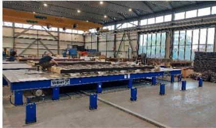
Und hier wird die Armierung für den Betonboden vorbereitet. Der Beton wird dann in diese Form gegossen und ausgehärtet.
